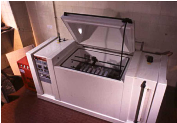
Fig. 9.13 Salt fog chamber
